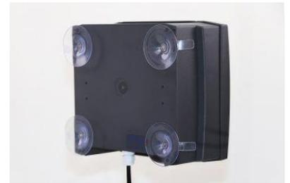
3. **Perfekter Halt:** Durch leichten Zug an der Window Antenne kann der feste Halt der Antenne am Fenster geprüft werden, Von einer Montage der Antenne bei Frost ist abzuraten. Das entstehende Kondenswasser erschwert die Abdichtung zwischen Fenster und Saugnäpfen.
