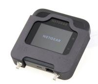
Mit unserem hauseigenen Montagecase kann der mobile 5G Router Nighthawk M6 Pro an der Wand montiert werden. Zusätzlich werden die Antennenanschlüsse für die Außenantenne für mehr Stabilität nach außen geführt. Dieser Nighthawk M6 Montage- & Antennenadapter sorgt also für festen Halt bei gleichzeitig maximaler Mobilität. Damit eignet er sich z.B. optimal zur Nutzung im Wohnmobil.
