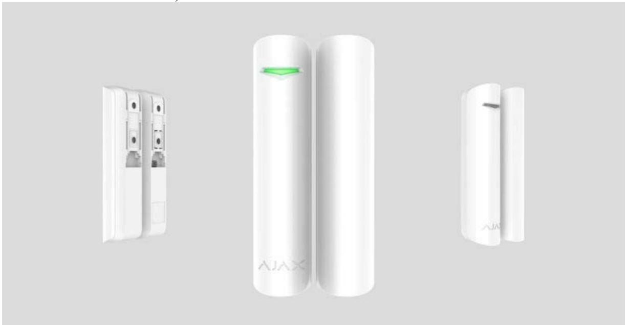
**DoorProtect** ist ein drahtloser Tür- und Fensteröffnungsmelder, der für den Einsatz in Innenräumen konzipiert ist. Er kann mit einer vorinstallierten Batterie bis zu 7 Jahre betrieben werden und kann mehr als eine Million Öffnungen erkennen. DoorProtect hat eine Buchse zum Anschluss eines externen Melders.
