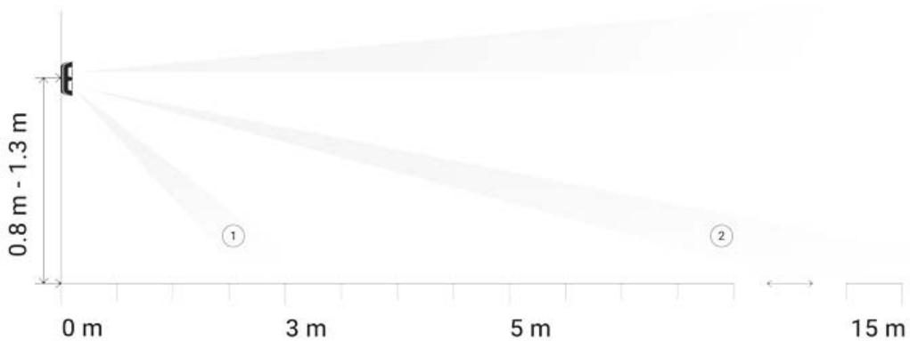
3. Setzen Sie MotionProtect Outdoor auf die SmartBracket-Befestigungsplatte. Verlassen Sie den Erfassungsbereich des Melders (horizontaler Erfassungswinkel  $90^\circ$ ) und stellen Sie sicher, dass keine Bewegungen innerhalb des Erfassungsbereichs
