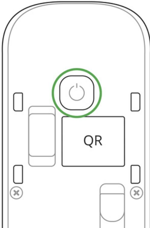
Damit die Erkennung und Einbindung erfolgen kann, muss sich der Melder im Empfangsbereich des Funknetzes der Hub-Zentrale befinden (an einem einzelnen geschützten Objekt). Beim Einschalten des Geräts wird für kurze Zeit eine Verbindungsanforderung an die Hub-Zentrale gesendet.
