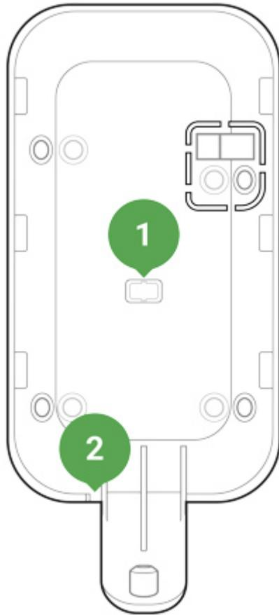
1. Für den Stromversorgungskabelausgang hinter der SmartBracket-Befestigungsplatte
