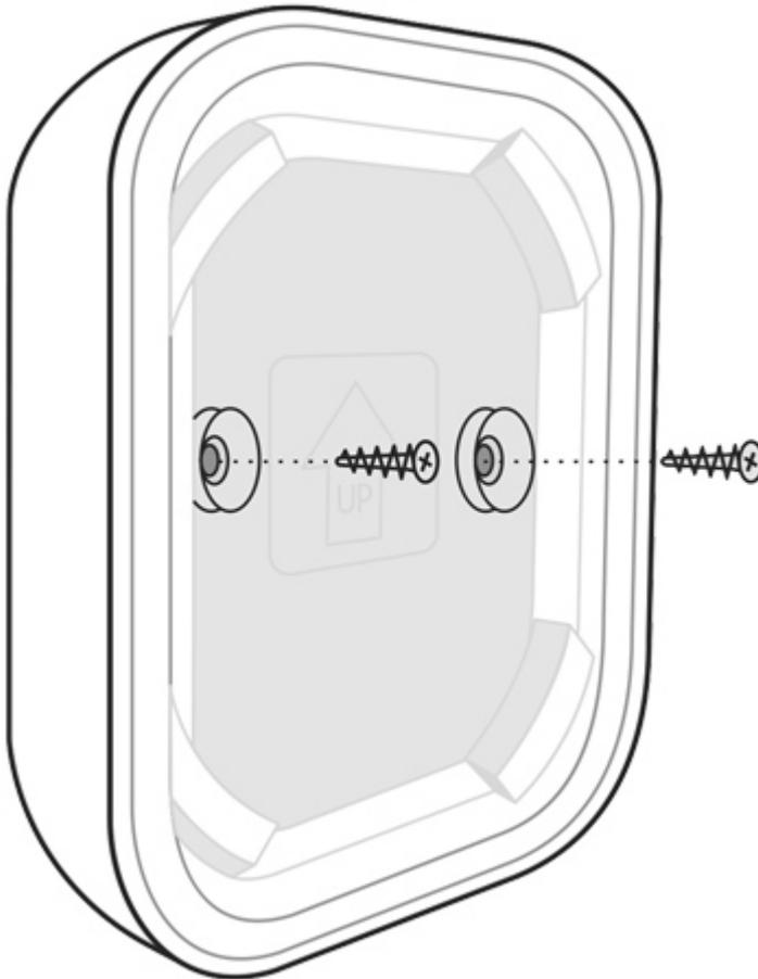
2. Die Sirene auf die Platte „SmartBracket“ aufsetzen und im Uhrzeigersinn drehen, dann mit der Schraube fixieren.
